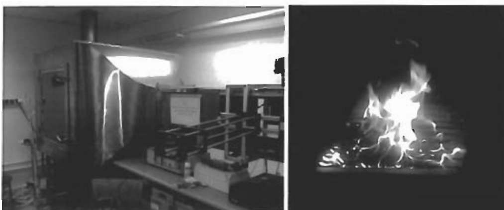
Rysunek 1. Komora spalania do badań rozkładu cząstek dymu podczas spalania płomieniowego oraz bezpłomieniowego różnych materiałów palnych
