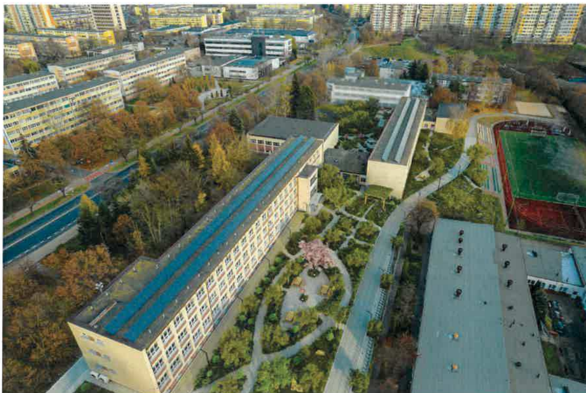
Fot. 1.1. Wizualizacja budynków ZSGE i CKZ z zaprojektowanymi ogrodami zielonymi w miejsce parkingów i panelami fotowoltaicznymi
